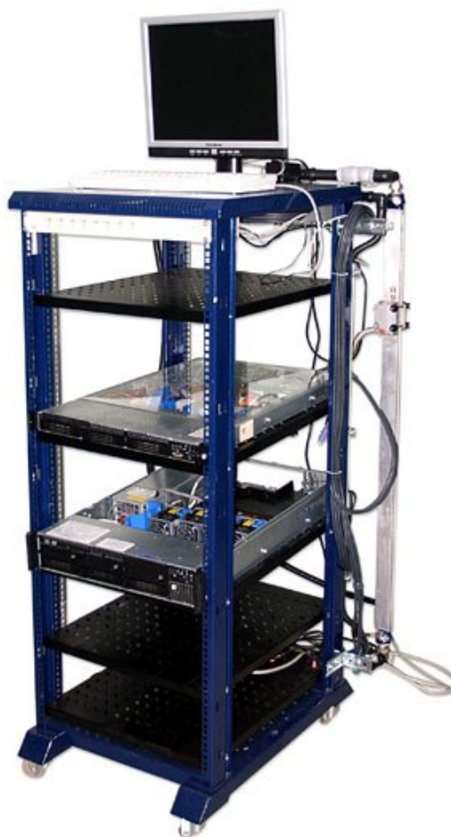
Система охлаждения Kraftway без использования нагнетающих помп
