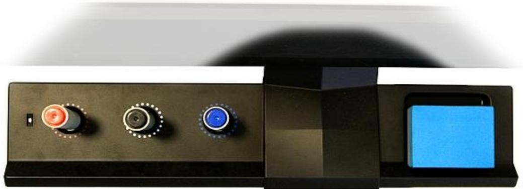
**Интеллектуальная подставка** для маркеров и «губки» позволяет автоматически присваивать цвет при изъятии маркера и переключать программное обеспечение в режим стирания при изъятии «губки»
